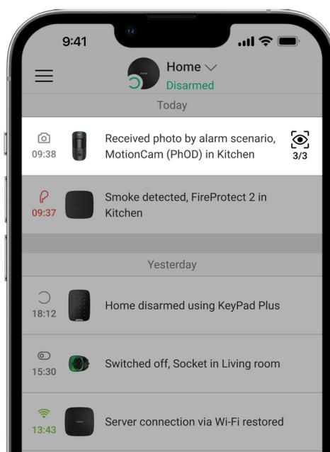
Mit der Funktion Foto nach Szenario kann ein Szenario für Bewegungsmelder mit Fotoverifizierung erstellt werden, sodass diese im Falle eines Alarms durch andere Ajax Geräte Fotos aufnehmen. So können Sie die Ursache für den Brandalarm feststellen und die Situation im gesicherten Objekt überwachen.
